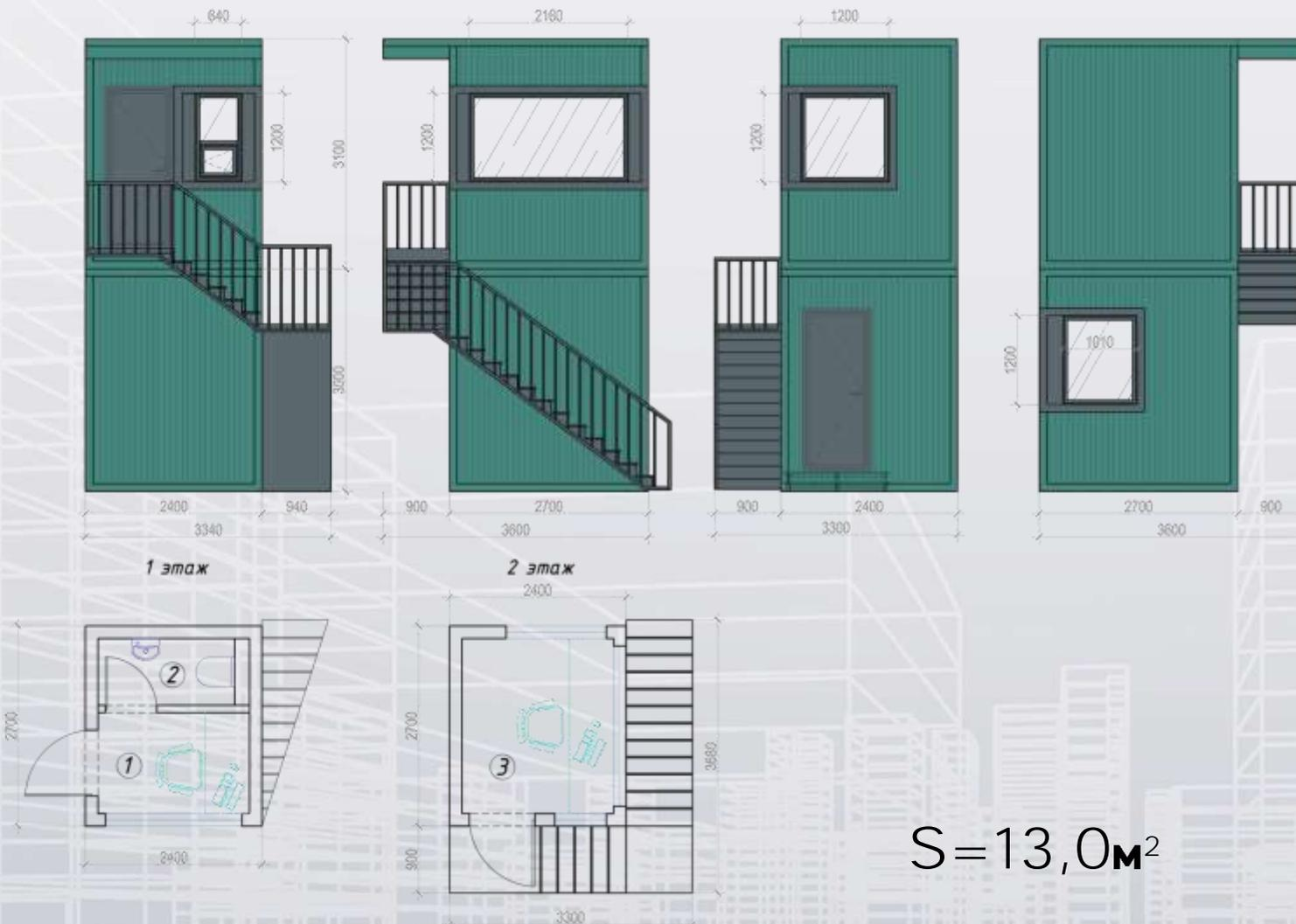
Двухэтажный модульный КПП класса Comfort. Основное помещение, оборудованное большим окном, расположено на втором этаже. На первом этаже – санузел и дополнительная комната для персонала. Фасад КПП выполнен из профилированного металлического листа в порошковой покраске.
