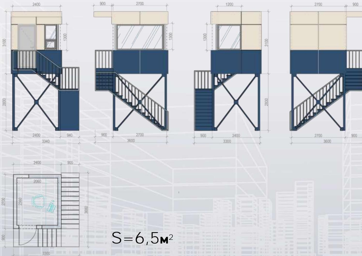
Модульный КПП класса Premium, приподнятый над уровнем земли до уровня второго этажа. Основное помещение КПП с большим окном устанавливается на специальные опоры для улучшения обзора охраняемой территории. Помещение охранника может быть укомплектовано кондиционером и системой громкой связи. Фасад КПП выполнен из современных композитных навесных панелей.
