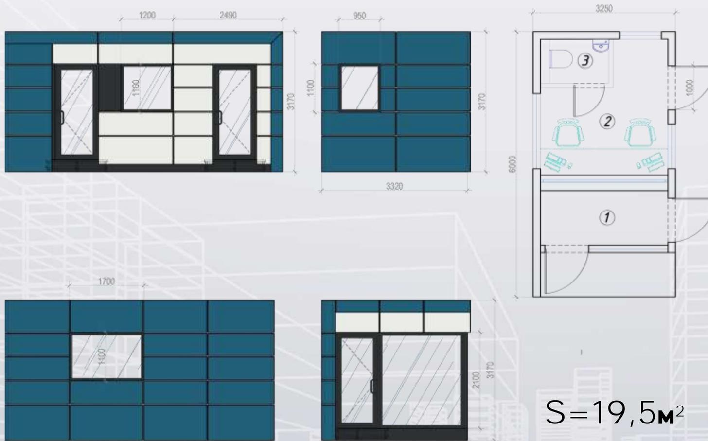
Одноэтажный модульный КПП/Проходная класса Premium. Внутреннее пространство состоит из основного помещения, увеличенной площади, санузла, а также дополнительного тамбура, имеющего автономный вход и выход, оборудованного турникетом для контроля доступа на охраняемую территорию. КПП оборудовано камерами слежения и светодиодными светильниками. Фасад КПП выполнен из композитных навесных панелей.
